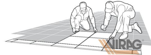
**1** Prima della posa, lasciare acclimatare le piastrelle per 24 ore a temperatura ambiente. Pulire e livellare il pavimento preesistente.
